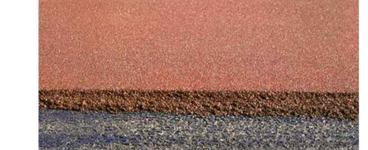
asfalto biologico drenante colorato
